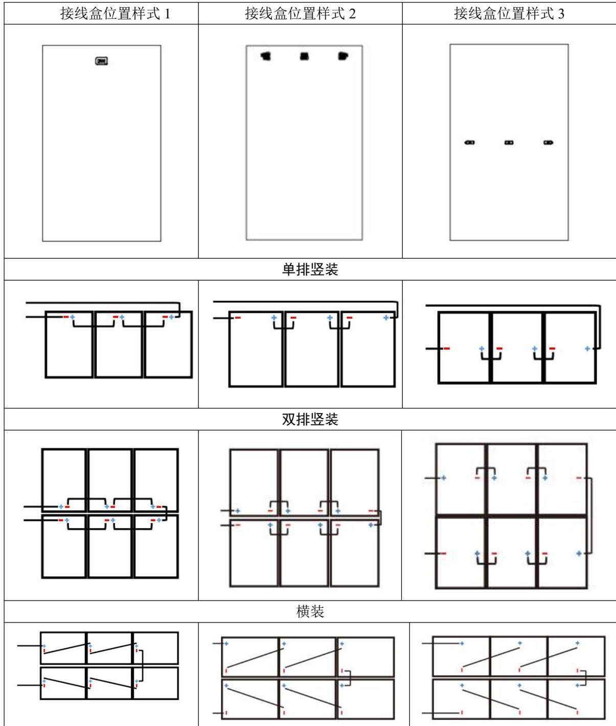
当组件连接成一串的时候，最终电压为单块组件之和，当组件是平行并联在一起的时候，最终电流为单块组件之和，不同电性能型号的组件不能连接在一串内。
