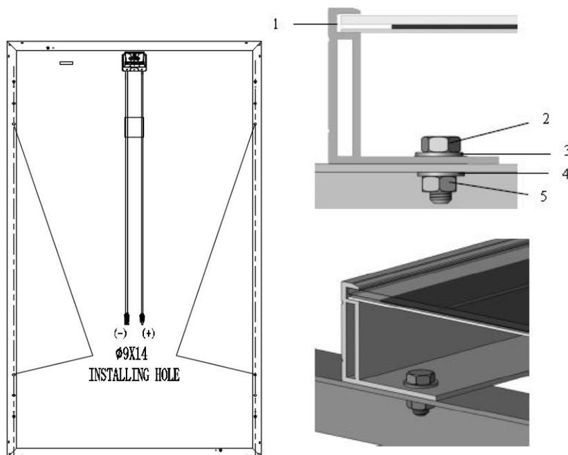
图 7 光伏组件的螺栓安装方式
